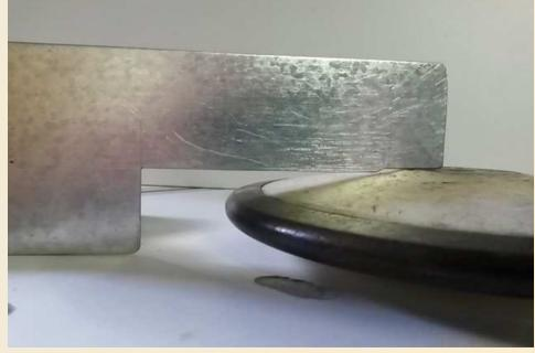
Contrôle de la longueur d'un marteau à l'aide d'un portique réalisé à partir d'un profilé aluminium rainuré de type véranda (achat magasin de bricolage)
