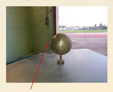
L'œillet d'attache du câble à l'horizontal. La tête doit rester en équilibre
