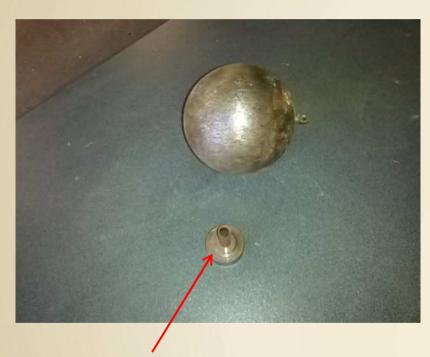
Support comportant un orifice circulaire horizontal à arête vive de 12mm
